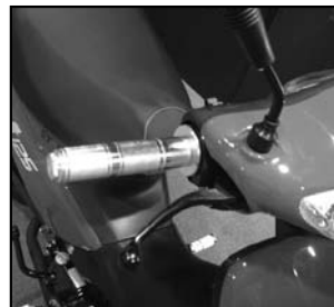
Palanca del freno delantero. El visor del nivel del líquido de freno se encuentra debajo de la carcasa del foco delantero.
