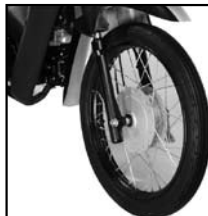
BIT 110 (Base) y BIT EL (Base) Rueda delantera con freno a tambor de expansión interna.
