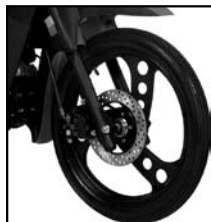
BIT EL (Full) Rueda delantera con freno a disco
