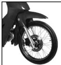
BIT 110 (Full) Rueda delantera con freno a disco
